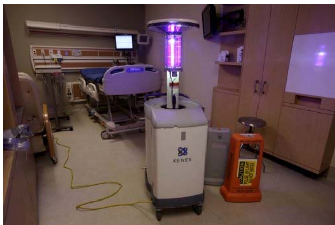
Una máquina que utiliza luz ultravioleta desinfecta la sala de un hospital en el Centro Médico Westchester en Valhalla, New York.
