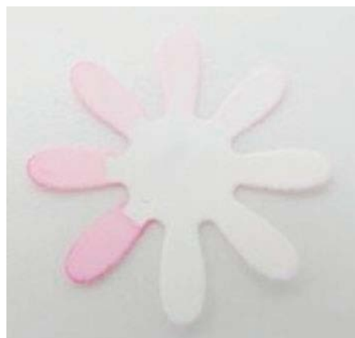
El sustrato de papel de nitrocelulosa con patrones florales usado para desarrollar una prueba diagnóstica rápida, múltiplex, para la infección por hepatitis C.
